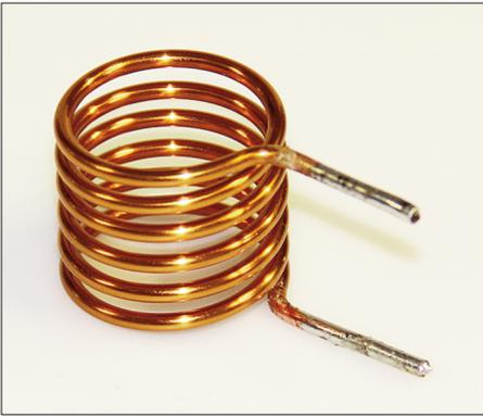
**Bild 6:** Beispiel für eine fertig vorbereitete, freitragende Luftspule
