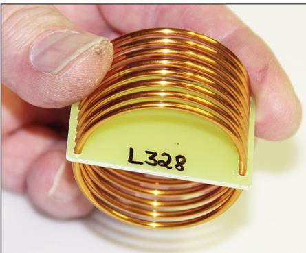
**Bild 7:** Um nicht versehentlich das falsche Drahtende zu kürzen, sollte der Spulenkörper so gehalten werden, wie im Text beschrieben.
