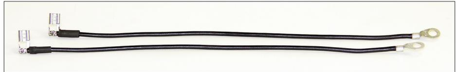
**Bild 50:** Vorbereitete Kabel für den Erdanschluss der Platinen
