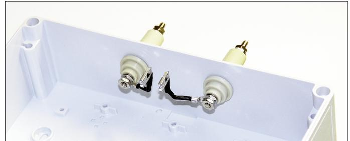
**Bild 51:** Eingebaute Durchführungsisolatoren mit Verbindungskabeln
