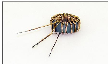
**Bild 35: Wicklung von T201 mit Mittelanzapfung**
