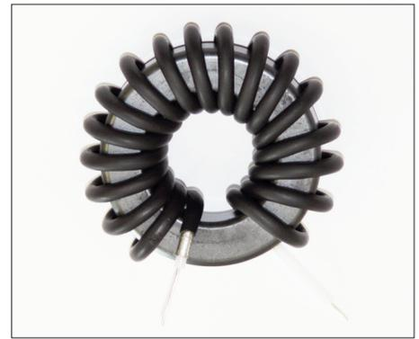
**Bild 36: Vorderseite von T202 mit abisoliertem Kabelende**
