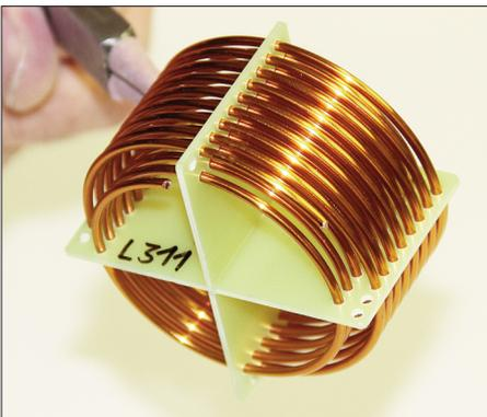
**Bild 22: L311 nach dem Kürzen der äußeren Wicklung**
