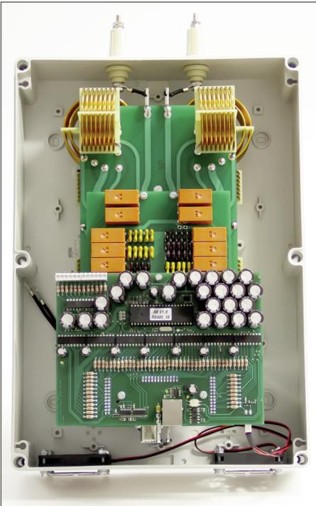
**Bild 54:** Fertig montierter Antennenkoppler mit abgenommenem Gehäusedeckel; die Erdungskabel der Kondensator- und Controlplatine sind noch nicht angeschlossen.
