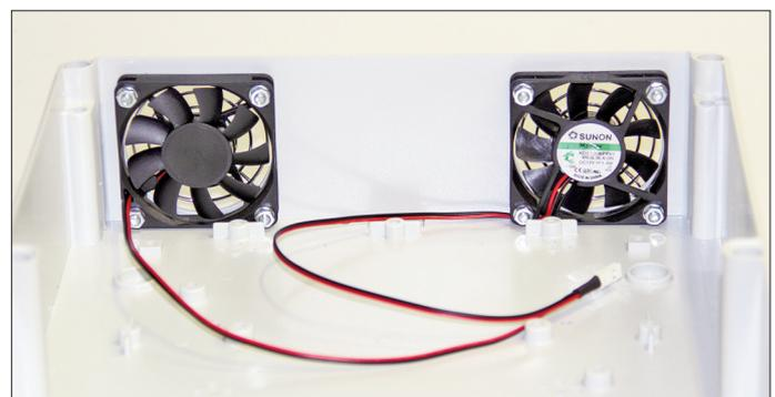
**Bild 52:** Einer der beiden Lüfter arbeitet als Eintritts- und der andere als Austrittslüfter
