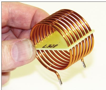
**Bild 10:** Fertig bearbeitete Luftspule L328
