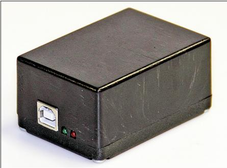
**Bild 49:** Fertig montierte Interface-Baugruppe, auf der Rückseite befinden sich der Anschluss für die Betriebsspannung und das Steuerkabel zum Antennenkoppler
