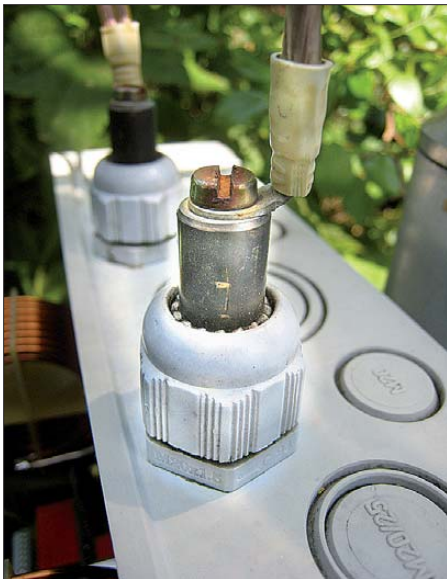
Bild 23: Hühnerleiterdurchführung: Messingstangen mit beidseitigem Sack-Gewinde M5
